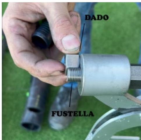
1) Avvitare la fustella al pinzone finquando la filettatura posteriore fuoriesca esattamente per l'intera altezza del dado.
