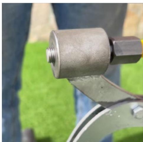
Unica !!!**ECCEZIONE!!!** al settaggio indicato sopra. !!!**PER TUBI di DIAMETRO 63!!!** La fustella deve essere avvitata al pinzone facendo sporgere la filettatura posteriore per la metà dell'altezza del dado e non per l'intera altezza. Inoltre il supportotubo deve essere svitato leggermente per avvicinarlo alla fustella frontale che eseguirà il taglio.
